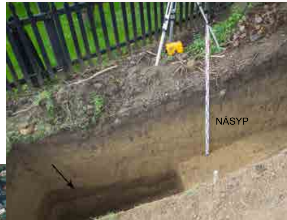
Sonda č. 1, severná časť, východný profil. Viditeľné sú hlinité vrstvy násypu pokryté vrstvou s vyšším podielom organických látok. Šipkou označená úroveň tzv. fosilnej pôdy, na ktorej bol násyp vybudovaný. Fot. A. Ginter
