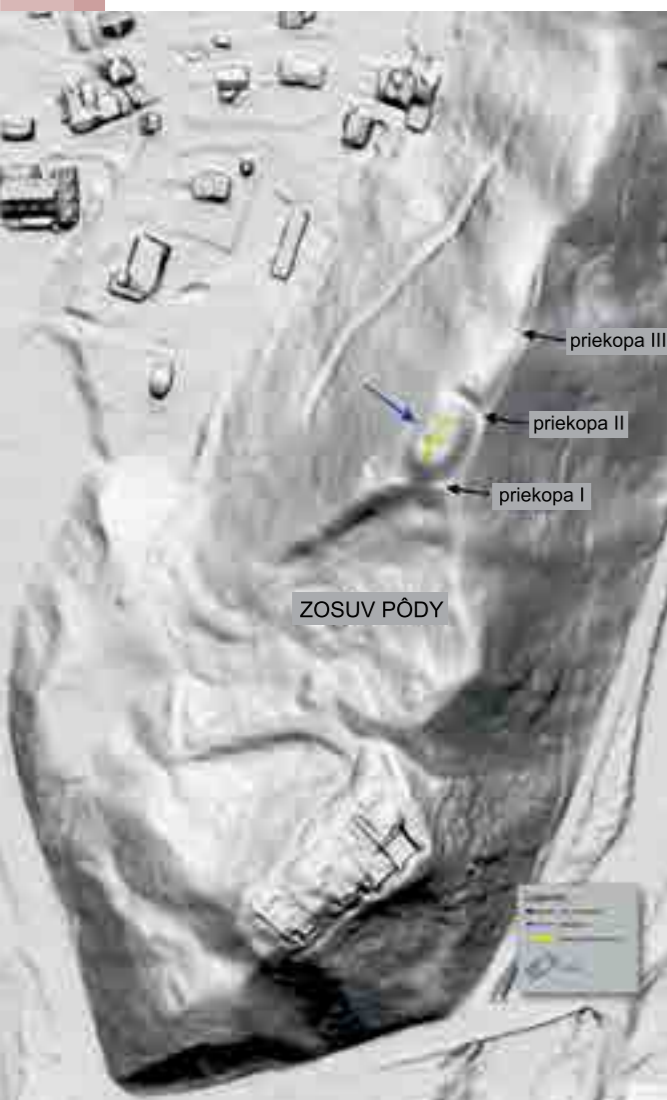
Digitálny model terénu vytvorený na základe údajov pochádzajúcich z leteckého laserového skenovania (LIDAR). Zdroj údajov: Štátna geodetická a kartografická databáza. Vypracoval A. Ginter
